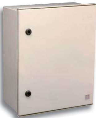
Armarios aislantes de polyester. Color Gris Claro RAL-7035. Material auto extingüible
